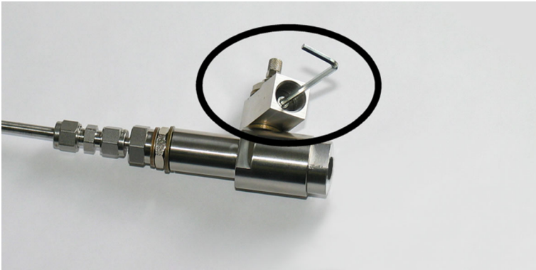
图 11 拆卸放气螺钉
